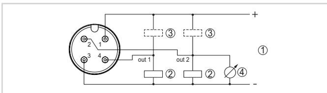
Schema di collegamento - trifilare con IO-Link (2 transistor o 4 ... 20 mA più 1 transistor)
